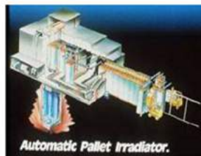
دستگاه قدیمی تولید کننده اشعه گاما
